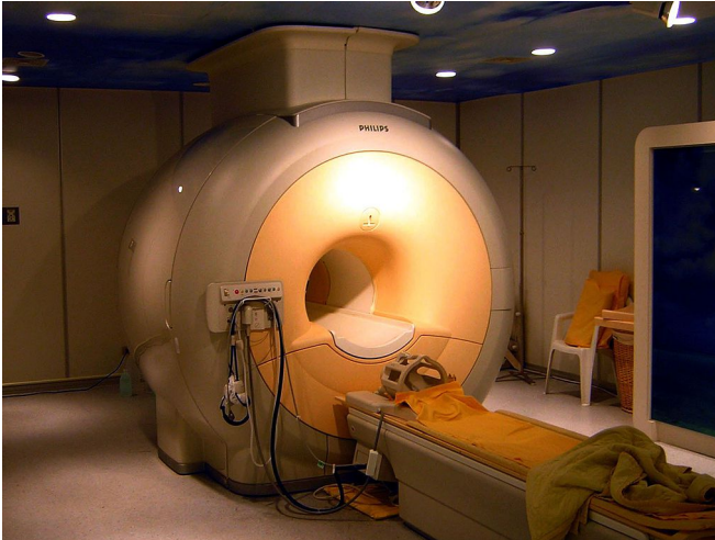
Рисунок 6: Слева: Современный ЯМР-томограф с полем до 3 Тл. Справа: примеры ЯМР-томограмм мозга с разной обработкой сигнала. С сайта [9].
