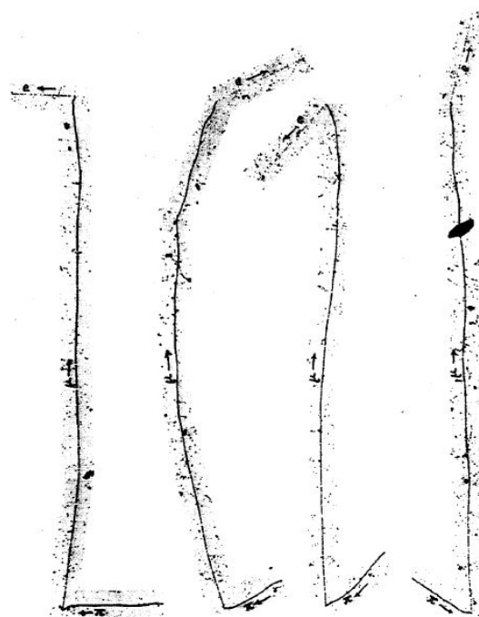
Рисунок 13: Следы последовательного распада пи-мезона в мюон и электрон. Изображение получено на фотоэмульсии. Из нобелевской лекции С.Пауэла [10].
