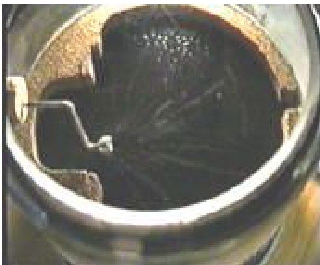
Рисунок 5: Демонстрационная диффузионная камера Вильсона. Источник частиц находится на конце изогнутого держателя слева, виден «веер» расходящихся от источника треков. С сайта [4].
