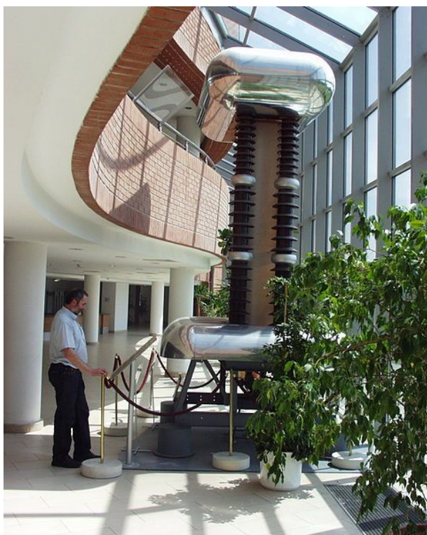
Рисунок 15: Генератор Ван де Граафа первого венгерского линейного ускорителя, в 1952 году достигнуто напряжение 1МВ. С сайта [13].
