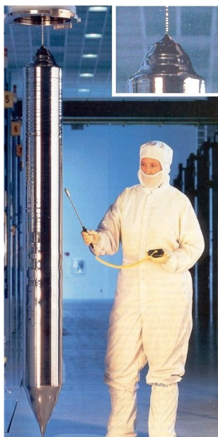
Рисунок 1: Монокристалл кремния, диаметр 200 мм вес около 150 кг. С сайта [2].
