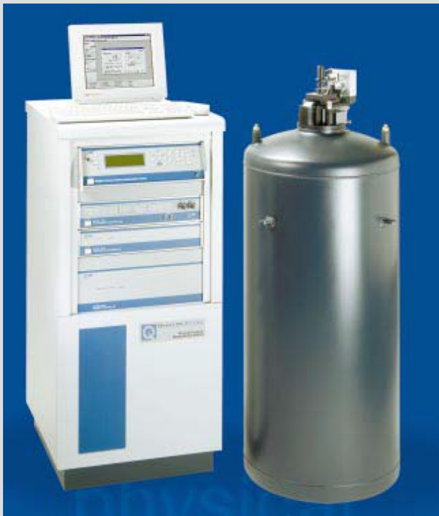
Фотография системы PPMS. Слева - стойка электроники, справа - дьюар.
