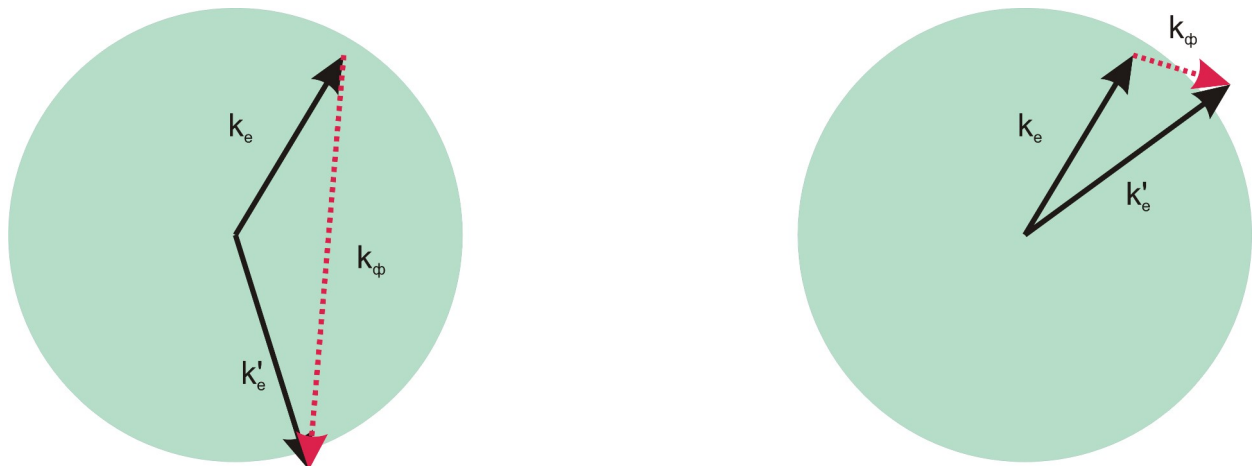
Рисунок 5: Схематическое изображение процесса с поглощением электроном фонона. Круговая область — заполненные электронные состояния, размытие плотности состояний вблизи поверхности Ферми не показано. Слева: случай высоких температур, когда большинство фононов имеют импульс k_\phi \sim k_D \sim k_F . Справа: случай низких температур, когда импульс фононов k_\phi \sim \frac{T}{\hbar s} \ll k_F .
