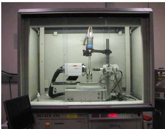
Рисунок 1 Слева: дифрактометр Bruker Smart Apex II (с сайта http://www.cif.iastate.edu/x-ray/apexii ). Справа: вид на образец в дифрактометре (фото автора). Справа налево по рис.: коллиматорная трубка, видеокамера, образец на гониометрической головке, полупроводниковый детектор.
