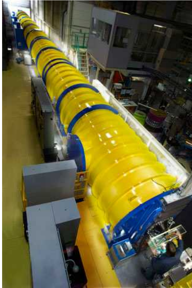
Рисунок 22: Канал для дифрагировавших нейтронов в малоугловом дифрактометре D11 Института Лауэ-Ланжевена. Длина около 40 метров, при работе канал откачивается для устранения рассеяния на воздухе. С сайта [17].
