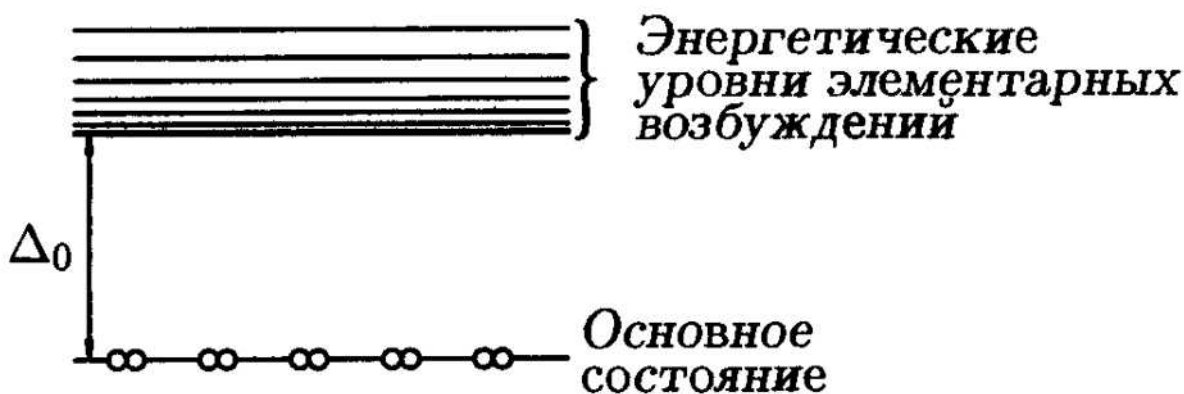
Рисунок 12 Схематическое представление основного состояния и спектра элементарных возбуждений сверхпроводника. Из книги [1].
