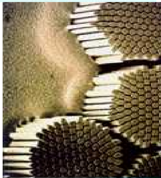
Рисунок 11 Структура сверхпроводящего кабеля, используемого на Большом адронном коллайдере [12]. Сверху: многожильный кабель (36 жил, полный диаметр около 15 мм), снизу: сечение одной жилы (диаметр около 1.5 мм) в разных масштабах. Каждая жила содержит около 6300 «волосков» сверхпроводящего провода (NbTi) толщиной около 6 мкм в матрице из бескислородной меди.
