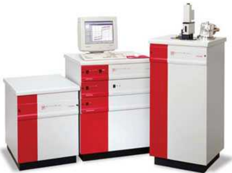
Рисунок 24: Фотография системы MPMS в опции с криостатом замкнутого цикла. Слева направо: стойка компрессора, стойка электроники, стойка с криостатом. С сайта фирмы Quantum Design [13].
