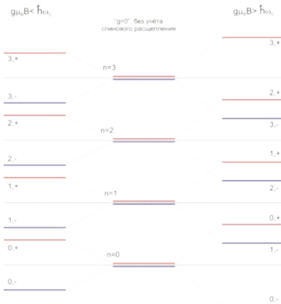
Рисунок 24: Схема чередования уровней Ландау с учётом спинового вырождения. В центре: без учёта зеемановского расщепления, каждый уровень Ландау двукратно вырожден по проекции спина. Слева: циклотронное расщепление больше зеемановского. Справа: зеемановское расщепление больше циклотронного.
