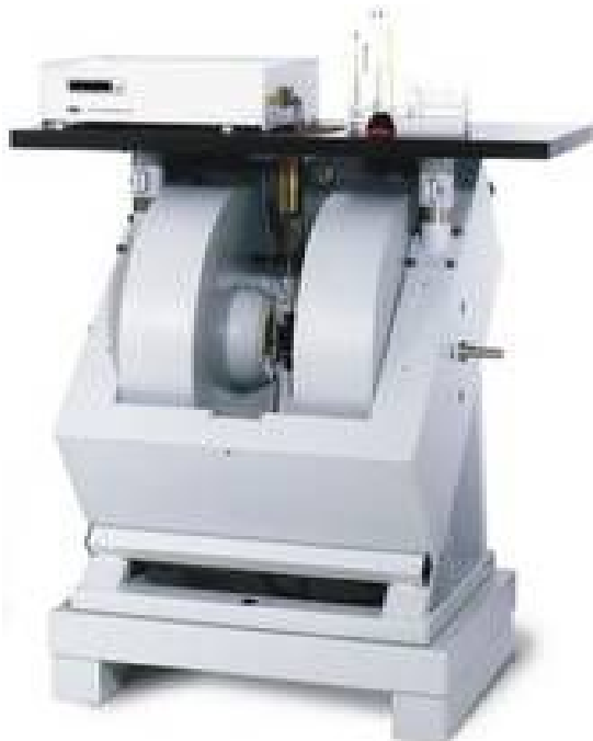
Рисунок 2 Резистивный водоохлаждаемый магнит на поле до 1.5 Тл в составе ЭПР спектрометра Bruker. С сайта bruker.com
