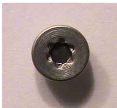
Рисунок 5: Капсула амерция-241 из бытового детектора дыма. Оболочка - алюминий, тёмный элемент в центре – диоксид амерция-241. С сайта [5].
