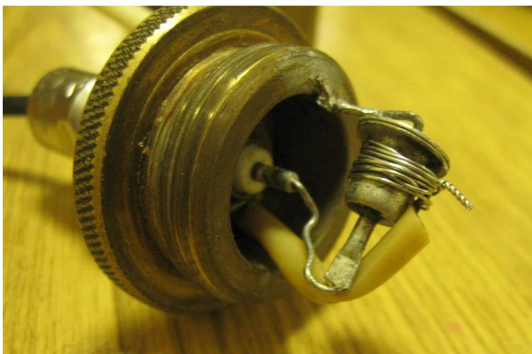
Рисунок 2: Исследуемый диод (один из вариантов, на разных установках могут быть разные диоды) и подсоединённый к его корпусу измерительный спай термопары.
