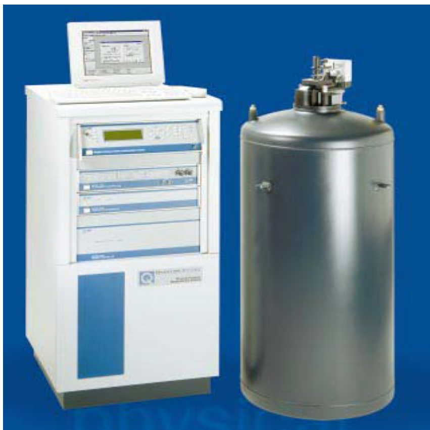
Рисунок 4: Фотография системы PPMS. Слева - стойка электроники, справа - дьюар. Из брошюры [6].
