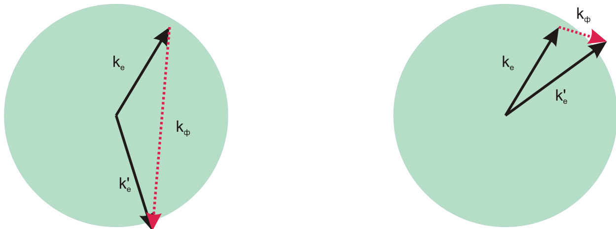
Рисунок 4: Схематическое изображение процесса с поглощением электроном фонона. Круговая область — заполненные электронные состояния, размытие плотности состояний вблизи поверхности Ферми не показано. Слева: случай высоких температур, когда большинство фононов имеют импульс k_\phi \sim k_D \sim k_F . Справа: случай низких температур, когда импульс фононов k_\phi \sim \frac{T}{\hbar s} \ll k_F .
