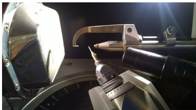
Рисунок 1 Слева: дифрактометр Bruker Smart Apex II (с сайта http://www.cif.iastate.edu/x-ray/apexii ). Справа: вид на образец в дифрактометре (фото автора). Справа налево по рис.: коллиматорная трубка, видеокамера, образец на гониометрической головке, полупроводниковый детектор.
