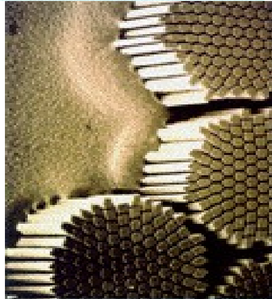
Рисунок 11 Структура сверхпроводящего кабеля, используемого на Большом адронном коллайдере [11]. Сверху: многожильный кабель (36 жил, полный диаметр около 15 мм), снизу: сечение одной жилы (диаметр около 1.5 мм) в разных масштабах. Каждая жила содержит около 6300 «волосков» сверхпроводящего провода (NbTi) толщиной около 6 мкм в матрице из бескислородной меди.
