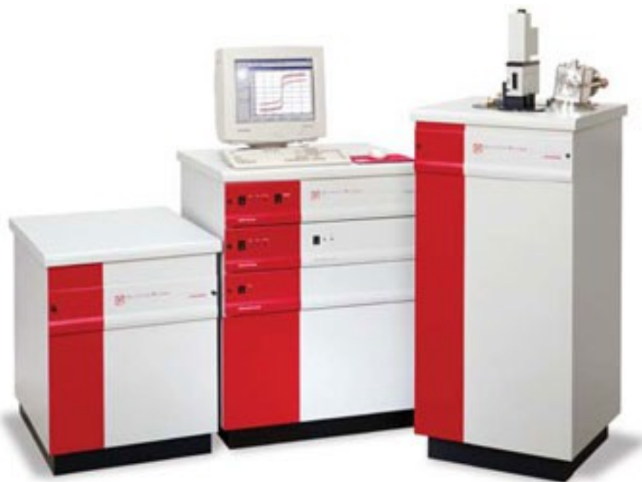
Рисунок 21: Фотография системы MPMS в опции с криостатом замкнутого цикла. Слева направо: стойка компрессора, стойка электроники, стойка с криостатом. С сайта фирмы Quantum Design [12].
