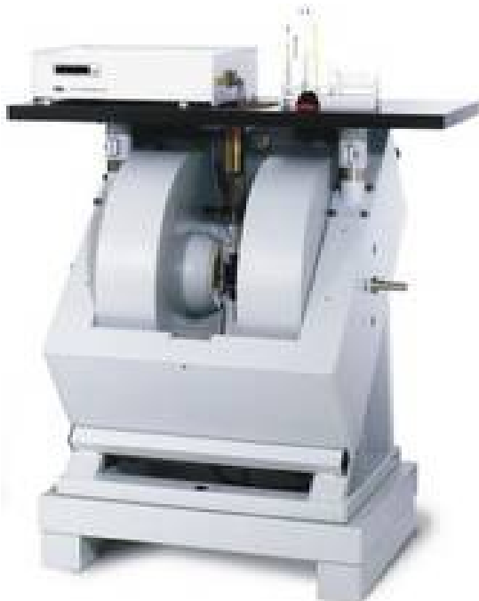
Рисунок 3 Резистивный водоохлаждаемый магнит на поле до 1.5 Тл в составе ЭПР спектрометра Bruker. С сайта bruker.com
