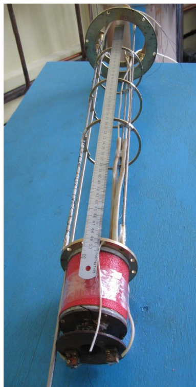
Рисунок 2: Сверхпроводящий соленоид на поле 8Тл. Фото автора.
