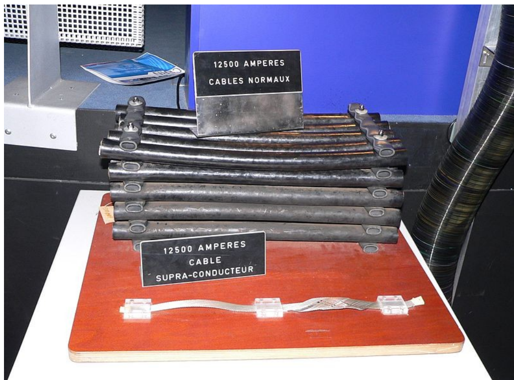
Рисунок 51: Используемые в ускорителях ЦЕРН кабели на Ампер. На заднем плане: из несверхпроводящего материала, на переднем плане: из сверхпроводника. С сайта [30].
